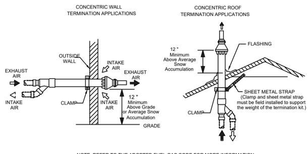
**3 CONCENTRIC INTAKE/FLUE DETAIL**
